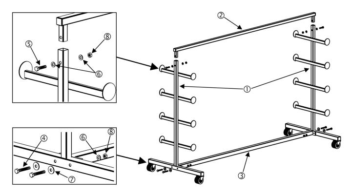
Um den Säulen-Transportwagen zu montieren, stecken Sie die Verstrebung mit Einsteckrohren ② von oben in die beiden Seitenteile ①.
