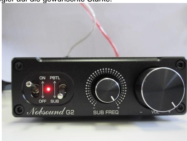
Abb. 8: Verstärkerbox im eingeschalteten Zustand
