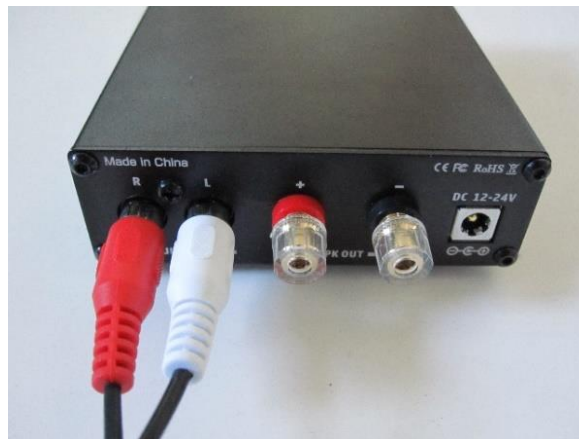
Abb. 4: Cinchanschluss verbunden mit Verstärkerbox
