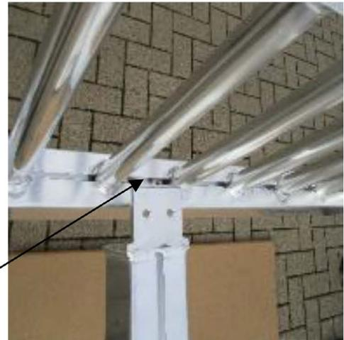
Einsteckmutter verschieben, sodass die Bohrungen deckungsgleich sind
