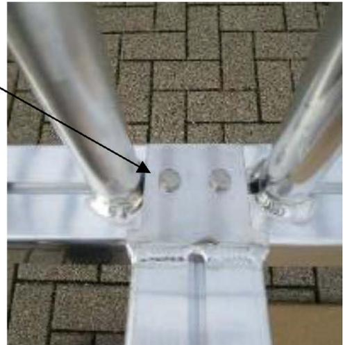
Zur Befestigung der Strebe am Tor die Bohrungen in der Verbindungsplatte deckungsgleich mit den Bohrungen in den angeschweißten Flachprofilen des Tores ausrichten. 2 Stck. Sechskantschrauben M8 x 65, DIN 933 von der Unterseite des Tores durch die Bohrungen stecken. 2 Stck. Unterlegscheiben Ø 8,4 DIN 9021 (Außendurchmesser 24 mm) auf die Schrauben aufstecken, 2 Stck. selbstsichernde Muttern M8, DIN 985 aufschrauben und anziehen (siehe Fotos unten).
