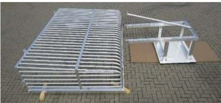
Für die Befestigung des Aufsatzes am Tor sind werkseitig in der Nut der Latte 4 Stck. Einsteckmutter eingeschoben. Die unten am Aufsatz angeschweißten zwei Winkel im Bereich der Einsteckmutter an der Latte platzieren. Die Einsteckmutter unter die Winkel schieben, sodass die Bohrungen in den Winkeln deckungsgleich mit denen der Einsteckmutter sind.
