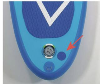
Presse die Folie nun mit viel Druck auf die undichte Stelle. Beschwere das Patch mit einem Gewicht und lass den Klebstoff ca. 12 Stunden trocknen. Danach gib nochmals Klebstoff auf den Rand der Reparaturstelle und lass alles nochmals 4-5 Stunden aushärten.
