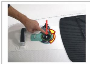
**Drücke den weißen Ventilstift mit einer leichten Drehbewegung, entgegen den Uhrzeiger-sinn, nach unten. Und lass die Luft entweichen.**
