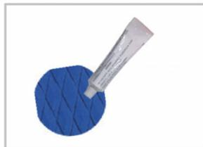
Gib etwas Klebstoff auf die zugeschnittene Reparaturfolie. Warte ca. 2-3 Minuten.
