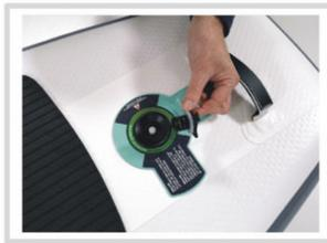
Öffne den Ventildeckel, indem du ihn gegen den Uhrzeigersinn drehst.
