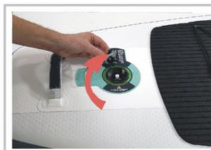
**Verschließe die Ventilkammer mit dem schwarzen Verschluss-deckel.**
