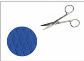
Schneide aus der Reparaturfolie ein ausreichend großes, wenn möglich rundes Stück aus. Wir empfehlen min. 5cm Abstand ausgehend von jeder Seite der defekten Stelle.
