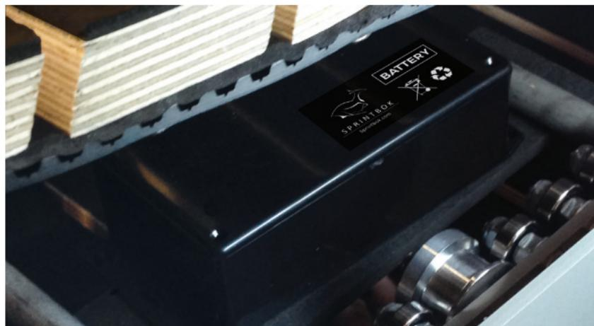
Um ein Zugang der Batterien zu bekommen, brauchen Sie nur die Schrauben des Gehäuses zu abschrauben und den oberen Teil zu entfernen.
