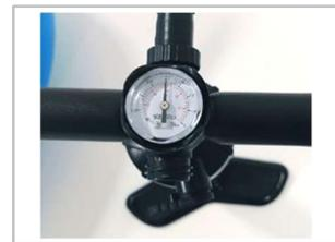
Ab einem Druck von ca. 0,7 Bar (10PSI) stellen Sie den Hebel auf „single action“ und pumpen das Board bis ca. 1,0-1,3Bar (15PSI) weiter auf. In diesem Bereich sind die Gleiteigenschaften Ihres Boards am Besten.
