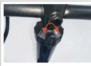
Die Doppelhubpumpe (3) ist mit zwei Pumpfunktionen ausgestattet. links: „single action“ und rechts: „double action“. Stellen Sie den Hebel zunächst auf „double action“ und pumpen Sie das Board bis ca. 0,7 Bar (10 PSI) auf.
