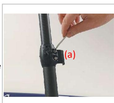
Sollte sich das obere Rohr nach Festklemmen des Klemm- verschlusses noch immer verschieben lassen, können Sie durch anziehen der Sechskant- chrauben (a) die Spannung der Klammer erhöhen. Achten Sie darauf, dass die Schrauben nicht zu stark angezogen werden. Die Kunststoff- manschette könnte ansonsten brechen.
