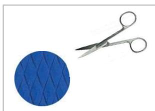
Schneiden Sie aus der mitgelieferten Reparaturfolie ein ausreichend großes, wenn möglich rundes Stück aus. Wir empfehlen min. 5cm Abstand ausgehend von jeder Seite der defekten Stelle.
