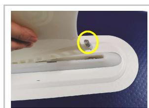
Stecken Sie die Schraube durch das Loch in der Finne. Bringen Sie die Finne in die geeignete Position um die Schraube am Plättchen festschrauben zu können.
