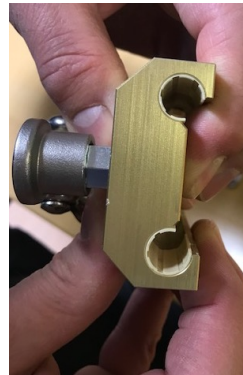
Rastbolzenstift an der Unterseite des Schlittens nach oben drücken, bis die Feststellmutter sichtbar wird.
