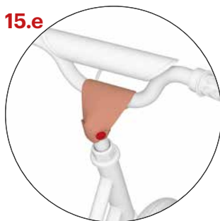
15.e Ponga la protección de espuma en el manillar y cúbrala con la funda de neopreno con velcro.
