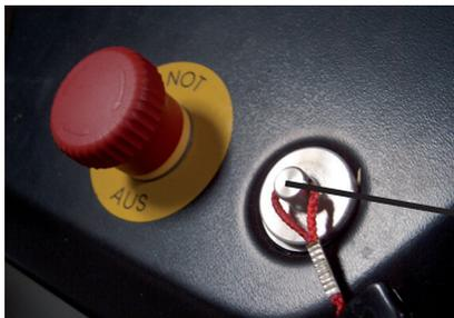
**Bitte beachten Sie:** Nur solange der Magnet auf dem Magnetsteckplatz befestigt ist, ist das Laufband funktionsfähig.
