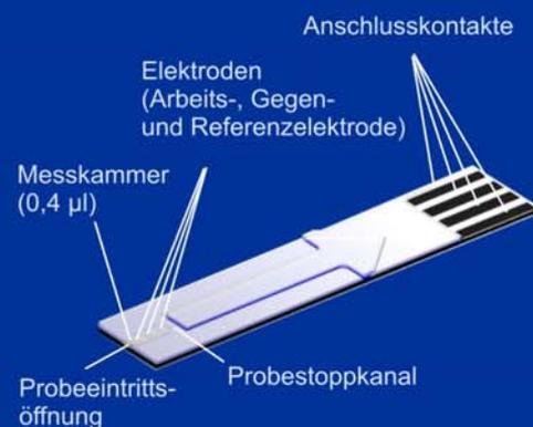
Abb. 1 Teststreifenaufbau
