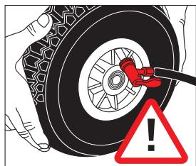
Bei bestimmten Kettcar-Modellen mit **luftbereiften Rädern** ist nicht auszuschließen, dass Kunststofffelgen bersten und unter ungünstigen Umständen Splitter zu Verletzungen führen können. Dies kann insbesondere bei starken Belastungen oder beim Aufpumpen der Reifen auftreten.
