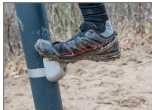
Die Stufen bestehen aus extrudiertem Aluminium mit einer rutschfesten Oberfläche. Aluminium hat eine hohe Korrosionsbeständigkeit und gewährleistet die Haltbarkeit des Produkts. Die Stufen wurden in Höhen von 34,7 cm und 54,7 cm montiert, was einen leichten Zugang zum Erreichen der Überkopfkaktivität ermöglicht.
