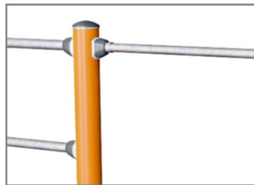
Alle Stangen, die für Klimmzüge vorgesehen sind, bestehen aus massiven, feuerverzinkten Stahlstangen (S235JR) mit einem Durchmesser von 32 mm x 138 m. Dieser Durchmesser bietet für jeden den richtigen Halt.
