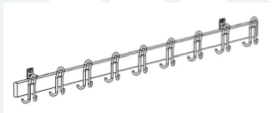
Die Hakenleiste darf mit maximal 10 kg / m belastet werden.
